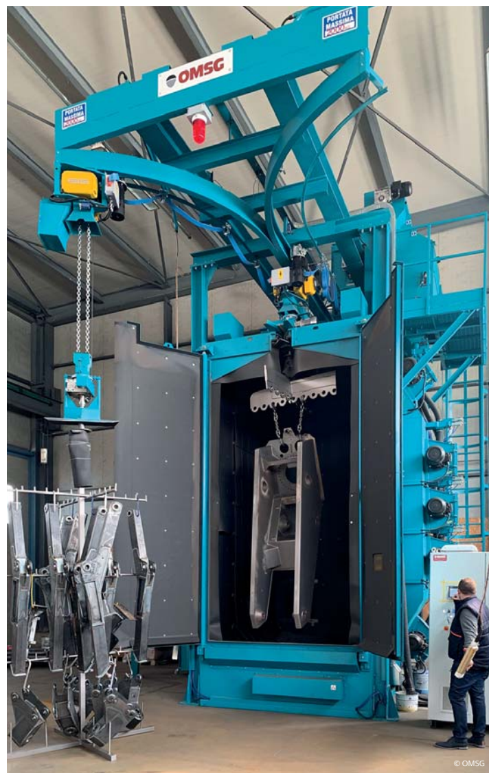
Ingresso di un manufatto nella nuova granigliatrice.
