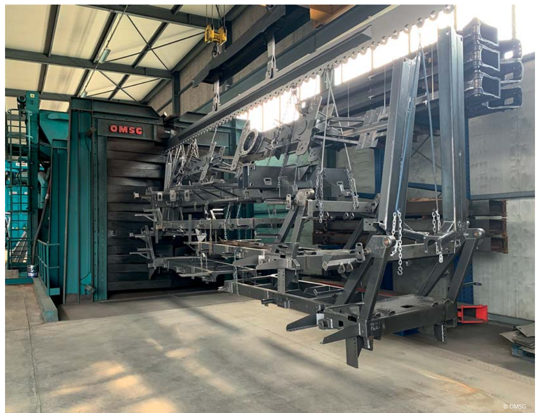
Alcuni manufatti dalle geometrie complesse granigliati da Carantini.
