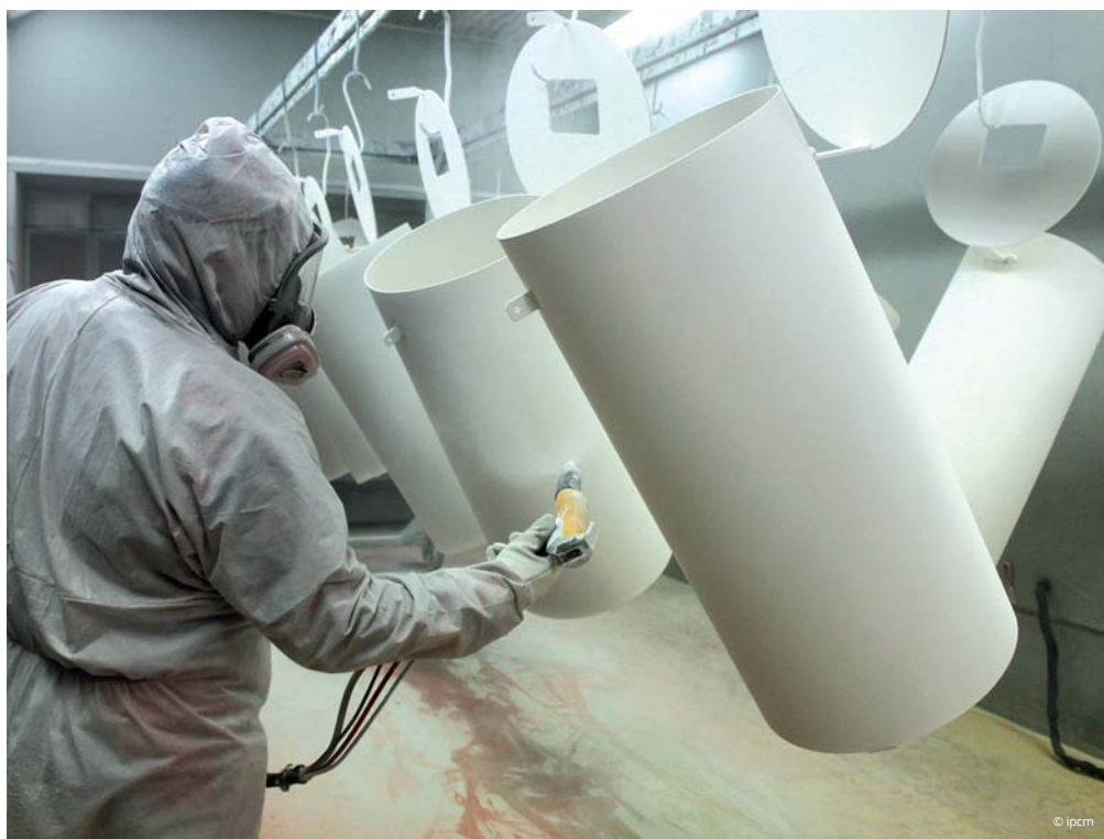
Finitura a polvere di manufatti di medie dimensioni.
